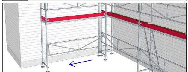
I det innvendige hjørnet så må rammene på de tilstøtende stillasene låses sammen med sammenkoblingsstag og klemmer.
