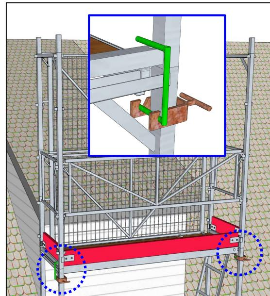
**Bruk av slike sikringsbeslag er ikke nødvendig ved bruk av rammer og toppstøtter med hull for låsekrok, og låsekrok for låsing av disse (ref. kap. 6.3, andre avsnitt).**
