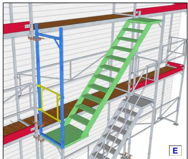
**Pass på at alle låsehakene på trapperekkrverk og enderekkrverk settes i «låst» posisjon.**
