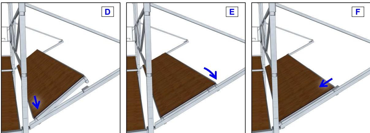
Monter så den ytterste plattformen på knektene. Legg plattformen litt skrått med den ytterste plattformkroken ned i knektens U-profil (fig. G), og skyv den utover og inn under låsebrakett ytterst (fig. H), inntil den innerste plattformkroken kan senkes ned i knektens U-profil (fig. I), og trekkes tilbake under låsebrakett på midten (fig. J), inntil den hviler mot ytterkant av den innerste plattformen.
