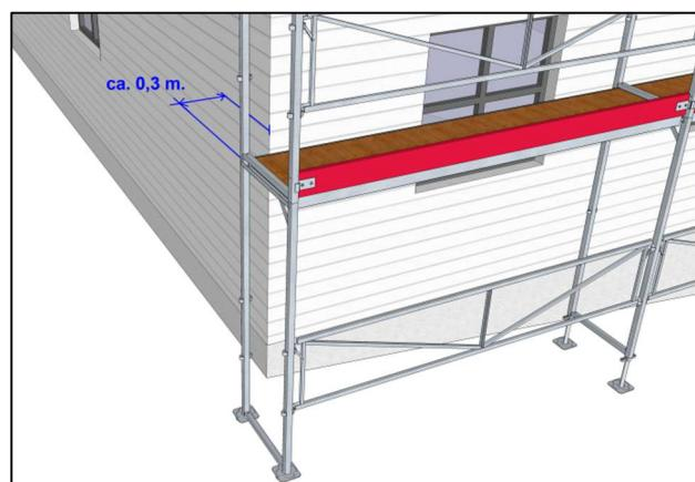
Man bør også planlegge plasseringen av stillaset på tilstøtende vegg, slik at avstanden fra rammen som kommer nærmest hjørnet og fram til den ytterste stolpen på den første rammen på aktuell vegg, blir en lengde som går opp i en tilgjengelig lengde på plattform / rekksverk / fotlist (1 m, 1,5 m, 2 m, eller 3 m).
