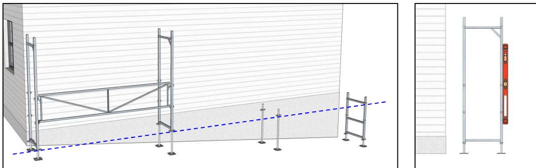
Monter først rammer på to par med føtter, og monter rekksverk mellom disse. Kontroller så at rammene er i lodd i forhold til fasaden, før man fortsetter fortløpende med rammer på resterende føtter og rekksverk mellom disse.
