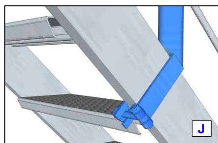
Når alle rammene i trappetårnet er låst godt fast til stillaset innenfor, og alle trapper og nødvendige rekkverk er montert, kan man ta bort rekkverk og fotlister i stillasfaget innenfor trappen, for å gi fri adkomst/passasje.
