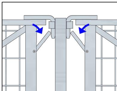
Ved montering av rekksikring på et enkelt stillasfag med lengde kortere enn 3 m må rammen i hver ende låses ned mot rammen i underliggende nivå med bruk av et sikringsbeslag (vnr.190) i hver ende av stillasfaget.
