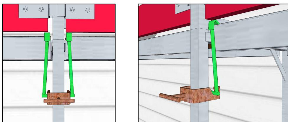
Ved bruk av utkraget plattform, enten på ut- eller innsiden av stillaset, må man benytte «**Stormsikringsbeslag for knekt**» som er tilpasset til dette formålet, for sikring av disse plattformene.
