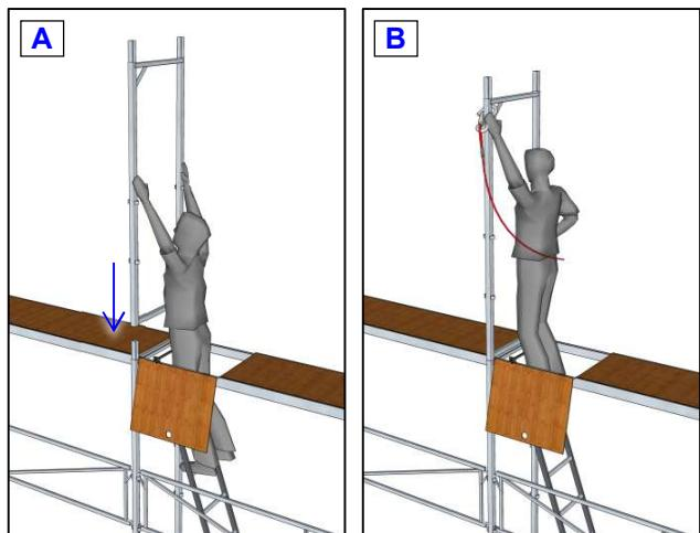
Man vil på denne måten få tilstrekkelig fallsikring til montering av neste ramme, og rekksverk mellom disse. Flytt så sikkerhetslinen med til neste ramme før man monterer neste rekksverk, osv.
