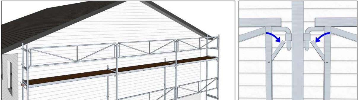
**OBS!** Toppstøtter og Rammer på øverste nivå sørger for låsing av plattformen, slik at denne ikke kan vippe eller løsne. Disse må derfor ikke utelates fra montering.
