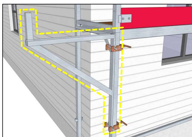
Legg så en plattform mellom den nærmeste rammen på motstående vegg og knekten, ved å hekte krokprofilene i endene av plattformene oppi U-profilene på hhv. rammen og knekten.
