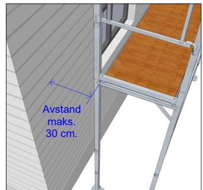
Dersom avstanden mellom stillasplattform og fasade blir større enn 30 cm så utløser dette krav til ekstra sikring på innsiden av stillaset, f.eks. i form av rekksverk eller knekter med ekstra plattform inn mot fasaden.
