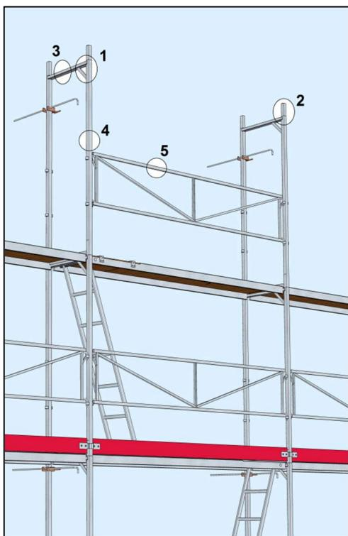
**Obs!** Ved innfesting av sikkerhetssele/line rundt sidestolpe i øvre hjørne på ramme ved skråtag (pkt. 1), rundt «stuss» på ramme (pkt. 2), eller rundt øvre tverrstokk (U-profil) på ramme (pkt. 3), så må minst 2 rammer være koblet sammen med et rekkverk.
