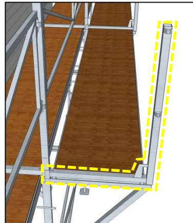
Etter monteringen av toppstøtter flyttes så rekkverk og fotlister som er montert mellom rammene innenfor knektene, ut på toppstøttene.
