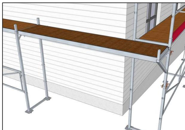
Monter så toppstøtter 1 m oppå både knekten og rammen på tilstøtende vegg.
