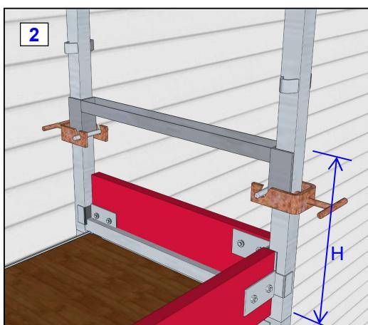
Ved montering av slike tverrstokker for plattformnivå høyere enn 2 meter over bakken må man også sørge for tilstrekkelig rekkrakkssikring til disse plattformene.
