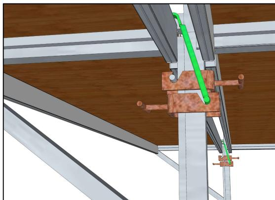
Ved stormsikring av utkragede plattformer så må stormssikringsbeslaget på plattformen i selve stillaset monteres på motsatt side av hvor knekten er montert.
