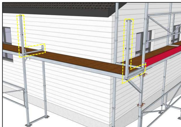
Monter til slutt rekkverk og fotlist mellom toppstøttene, samt enderekkverk og endefotlist mellom rammen og toppstøtten oppå knekten.
