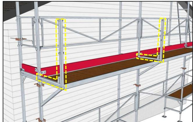
Etter montering av toppstøtter flyttes så rekkekverk og fotlister som er montert mellom rammene innenfor knektene, ut på toppstøttene.
