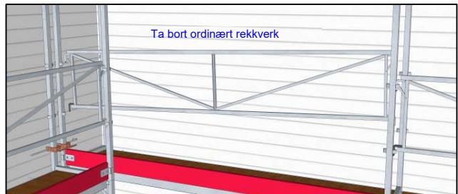
Juster lengden på rekkverksstagene og lås dem med å stramme låseskruen (C).
