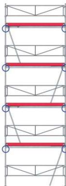
Når beregnet kraft i forankringspunkt overstiger 1,8 kN må det brukes 2 klemmer pr. veggfeste.
