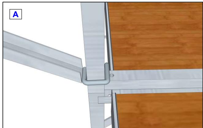
Vend så firkantrøret med U-profil i enden oppover og tre U-profilen sideveis inn på den ytterste stolpen på rammen rett i overkant av rekkverk (fig. B), og før den ned mellom kroken på rekkverket og stolpen på rammen (fig. C). Dette vil låse U-profilen slik at den ikke løsner.
