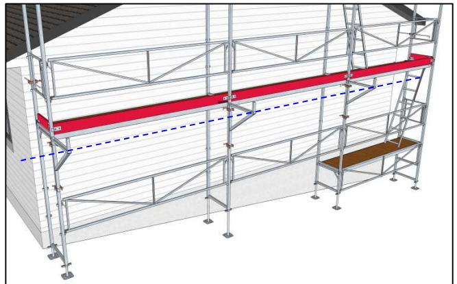
Monter så plattformer oppå knektene, ved å hekte krokprofilene i endene av plattformene oppi U-profilene på toppen av knektene.
