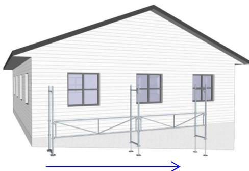
Optimalt så bør ikke avstanden mellom innsiden av montert stillasplattform og fasaden overstige 30 cm. Vær her spesielt obs på evt. takutstikk eller utbygg på fasaden når en planlegger, da dette kan påvirke avstand til fasaden.
