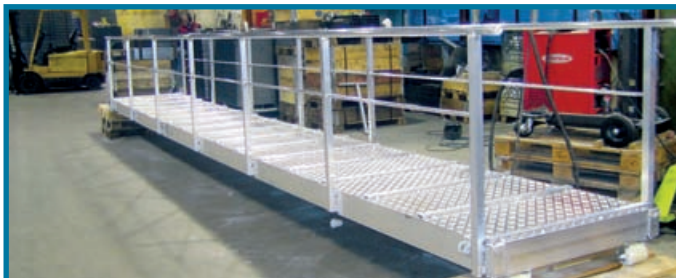
8 x 1 m landgang med dobbelt rekkverk, produsert for CCB
