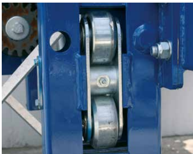
Rolig løp pga. tandemruller (MX 1524 / MX 2024)
